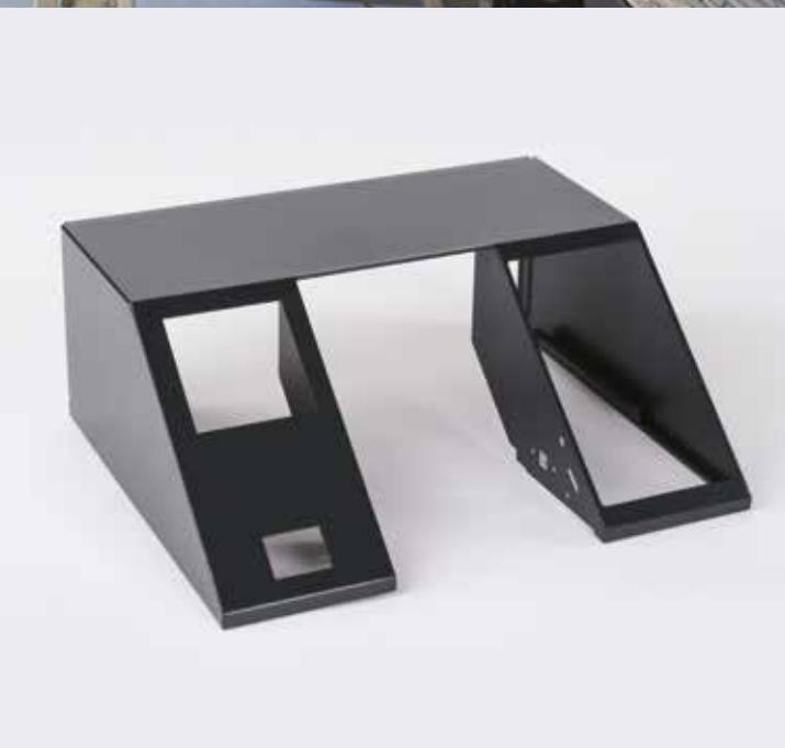
Ici commence le processus d'exécution des coupes, poinçonnages, cintrages, marquages, traitements de surface, tout usinage complémentaire et d'assemblage, pour la réalisation de composants en tôle aux formes les plus complexes.
